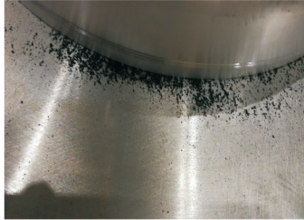
(b) 分子筛支柱绝缘子附近分解物
